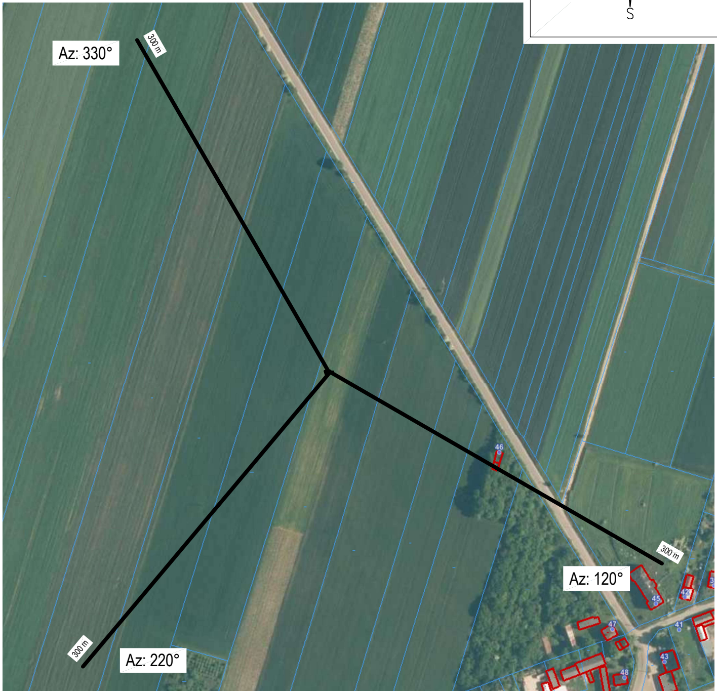
Rys. 1. Rzut poziomy osi głównej wiązki promieniowania w odległości do 200 i 300 metrów od środka elektrycznego anten sektorowych.
