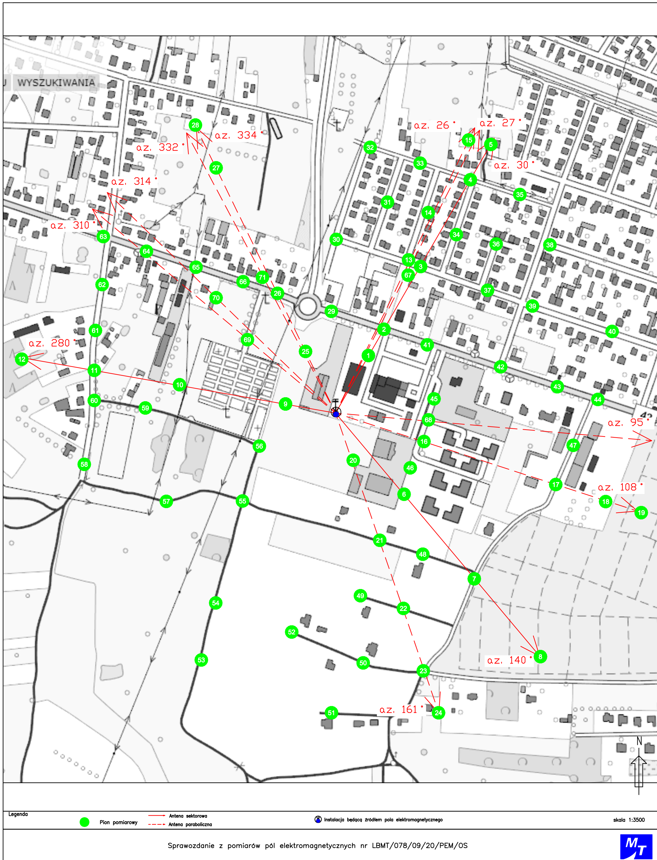
Rys.1 Lokalizacja pionów pomiarowych
