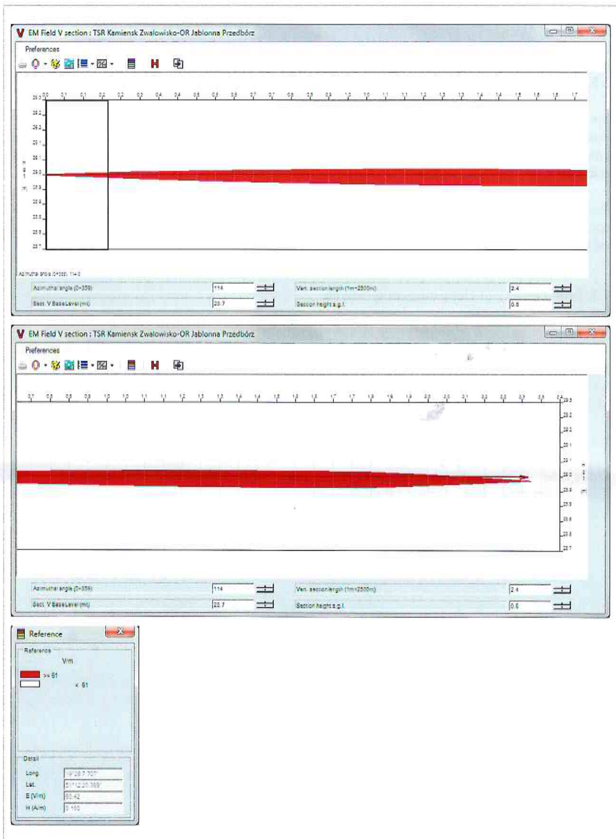
Rys.1. Rozkład poziomów pola elektromagnetycznego w otoczeniu nowo projektowanej linii radiowej w przekroju pionowym.
