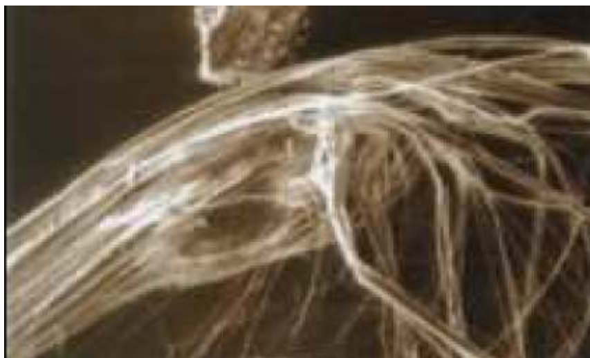
Rysunek 1. Powiększone 1000x włókna azbestu
